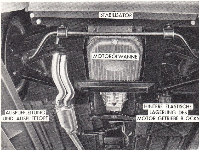
Einzelradaufhängung durch Schraubenfedern und hydraulische, doppelwirkende Teleskop-Stossdämpfer. Stabilisator, mit den unteren Querlenkern verbunden.
